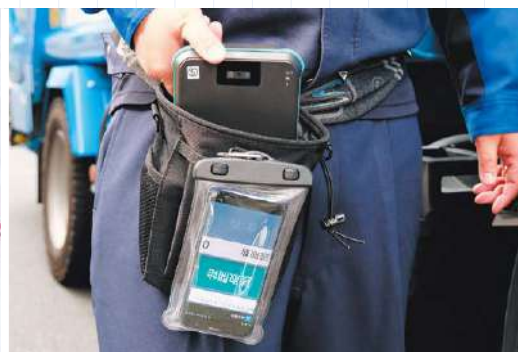
▲ハンドリーダーUF-3000の持ち手(オプション)を外し、ウェアラブルデバイスとして運用
